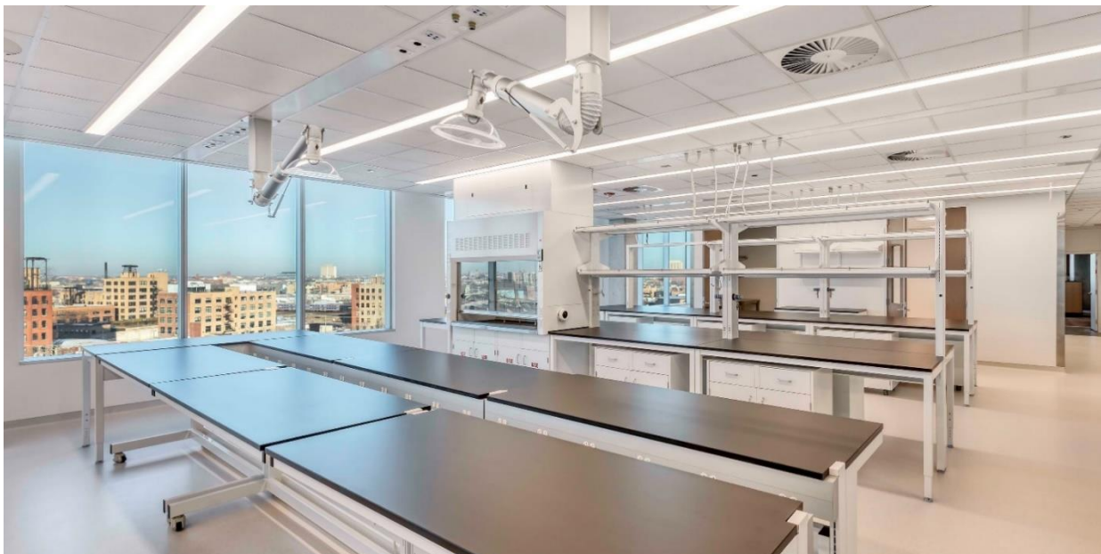
Photo 4. Tables mobiles avec services derrière pour salle d'instrumentation
