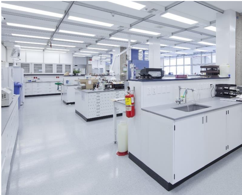
Photo 2. Dossieret pour les laboratoires de recherche – service perpendiculaire Ce type de dossieret est massif et limite grandement la profondeur des paillasses.
