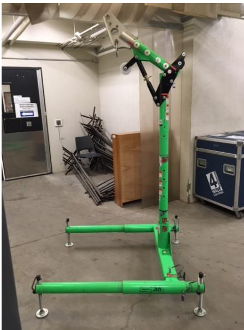
Photo 5. Exemple d'une potence et base fixe de potence
