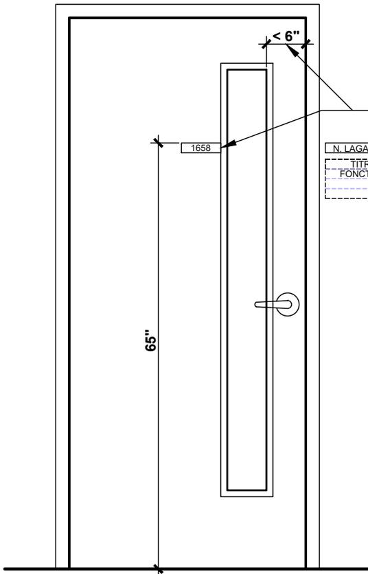
POSITIONNEMENT DE LA PLAQUETTE D'IDENTIFICATION CONTRE LA MOULURE DE FINITION LORSQUE LA DIMENSION EST INFÉRIEURE À 6"
