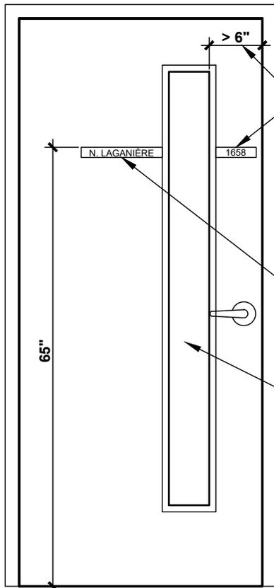
POSITIONNEMENT DE LA PLAQUETTE D'IDENTIFICATION CONTRE LA MOULURE DE FINITION LORSQUE LA DIMENSION EST SUPÉRIEURE À 6"
